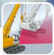
建設機械：周辺検知 Construction
